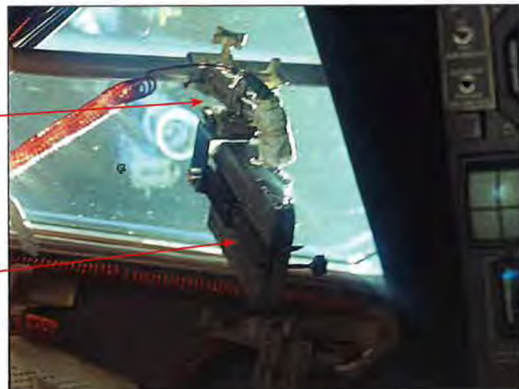
Abb. 5: Am Fenster der Mondlandefähre montierte DAC Pfeil oben: Haltegestänge Pfeil unten: Filmkamera
