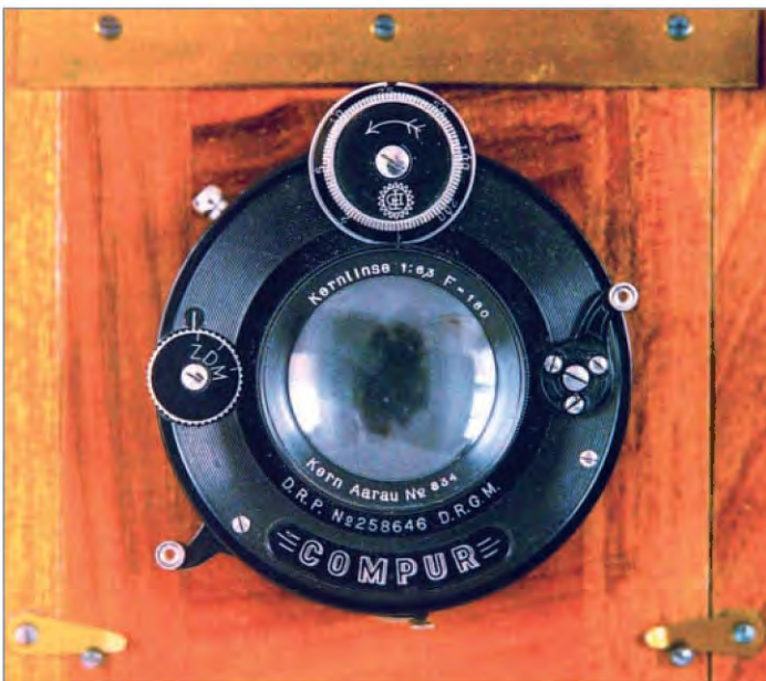
Abb. 22: Frey-Holzkamera, Detail-Abbildung der Kernlinse 6,3/180 in Compur-Verschluss
