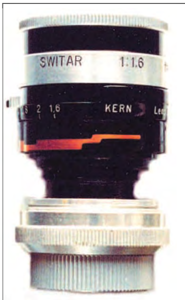
Abb. 31: Teilzerlegtes Kino-Switar 1,6/5,5 mm mit entferntem Schärfentiefenableserring und abgezogener Lochhülse.
