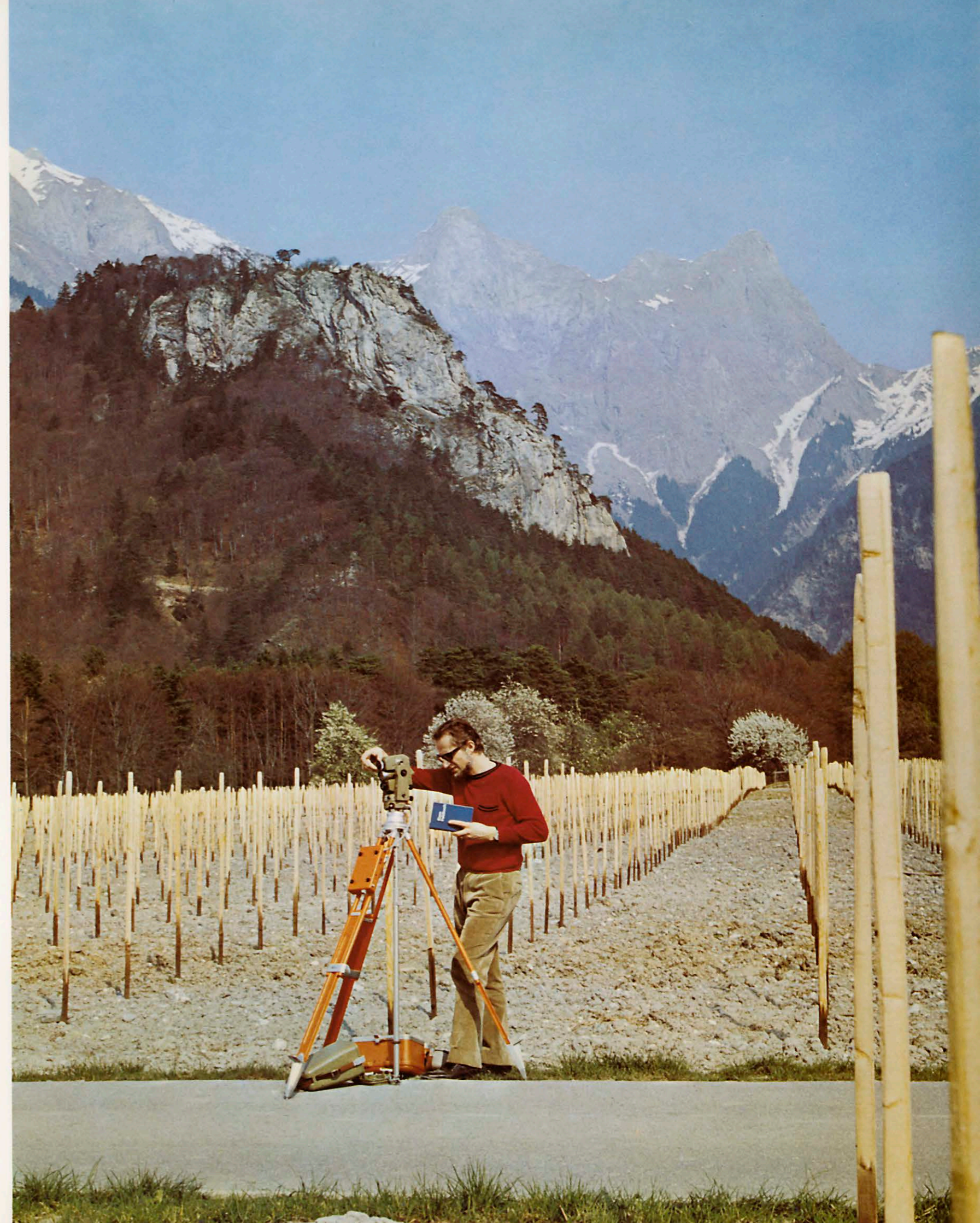
Katastervermessung in einem Rebberg bei Fläsch (Graubünden) mit dem Ingenieurtheodolit Kern K1-S und dem damit kombinierten elektrooptischen Distanzmessgerät Kern DM 500
