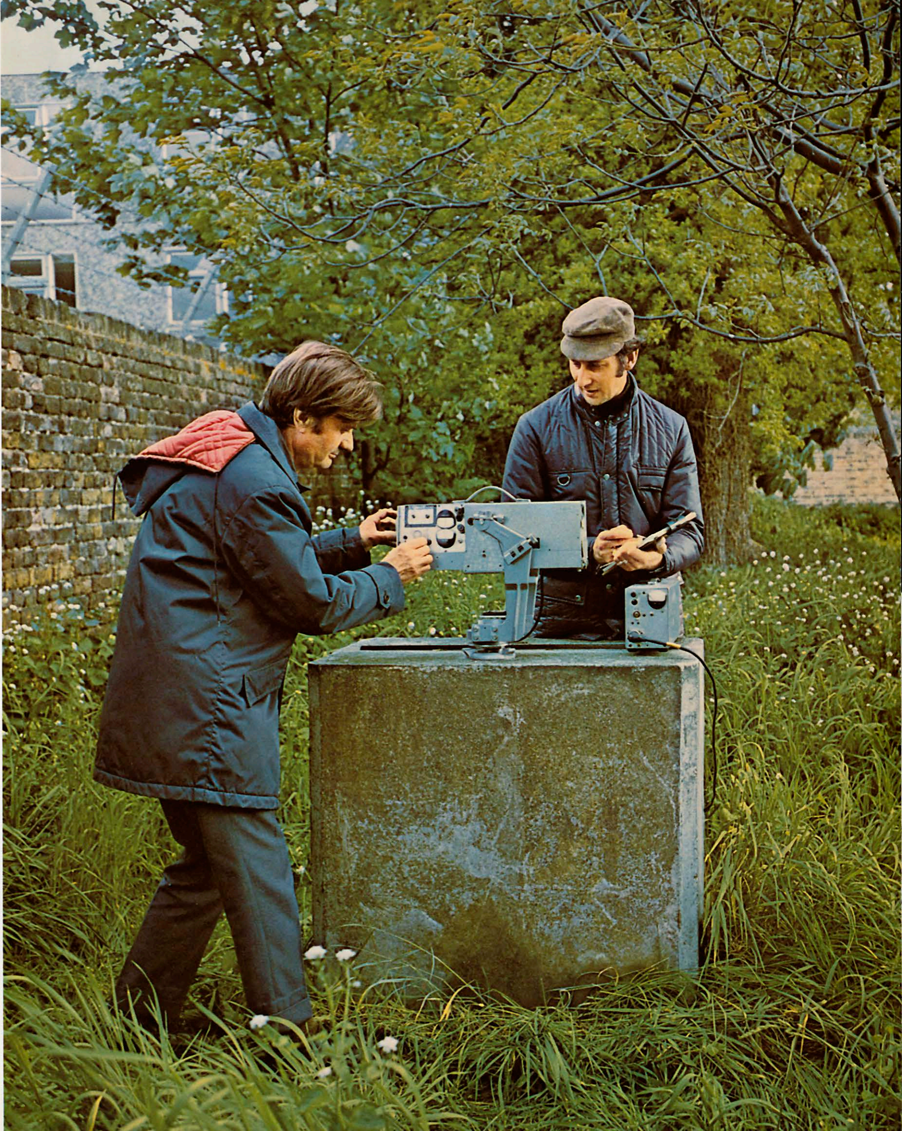
Dr. K. D. Froome (links) und R. H. Bradsell, die geistigen Väter des Mekometers, mit dem Mekometer III auf der Längenmess-Prüfstrecke des National Physical Laboratory in Teddington, England
