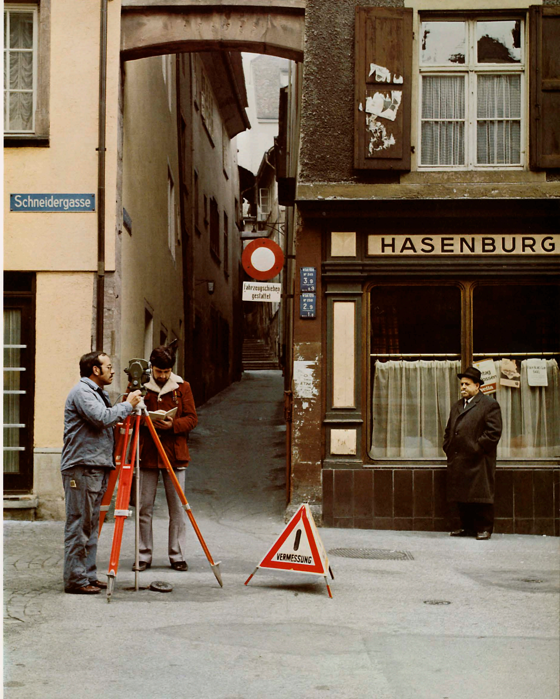
Der Sekundentheodolit Kern DKM2-A mit aufgesetztem elektrooptischem Distanzmessgerät Kern DM 500 bei der Detailaufnahme in der Altstadt von Basel.
