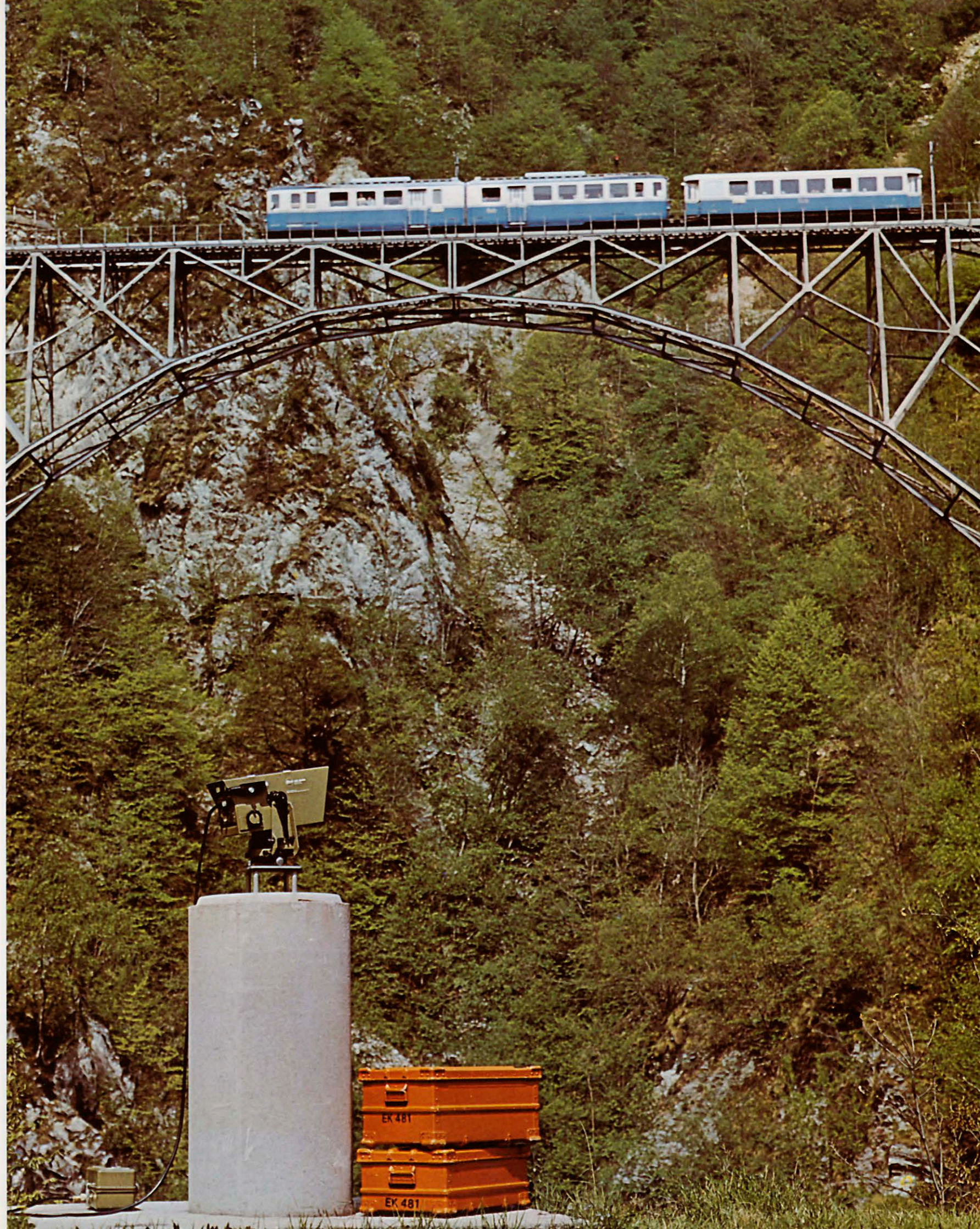
Kontrollmessung an einer Eisenbahnbrücke bei Camedo (Centovalli, Tessin) mit dem Mekometer Kern ME 3000
