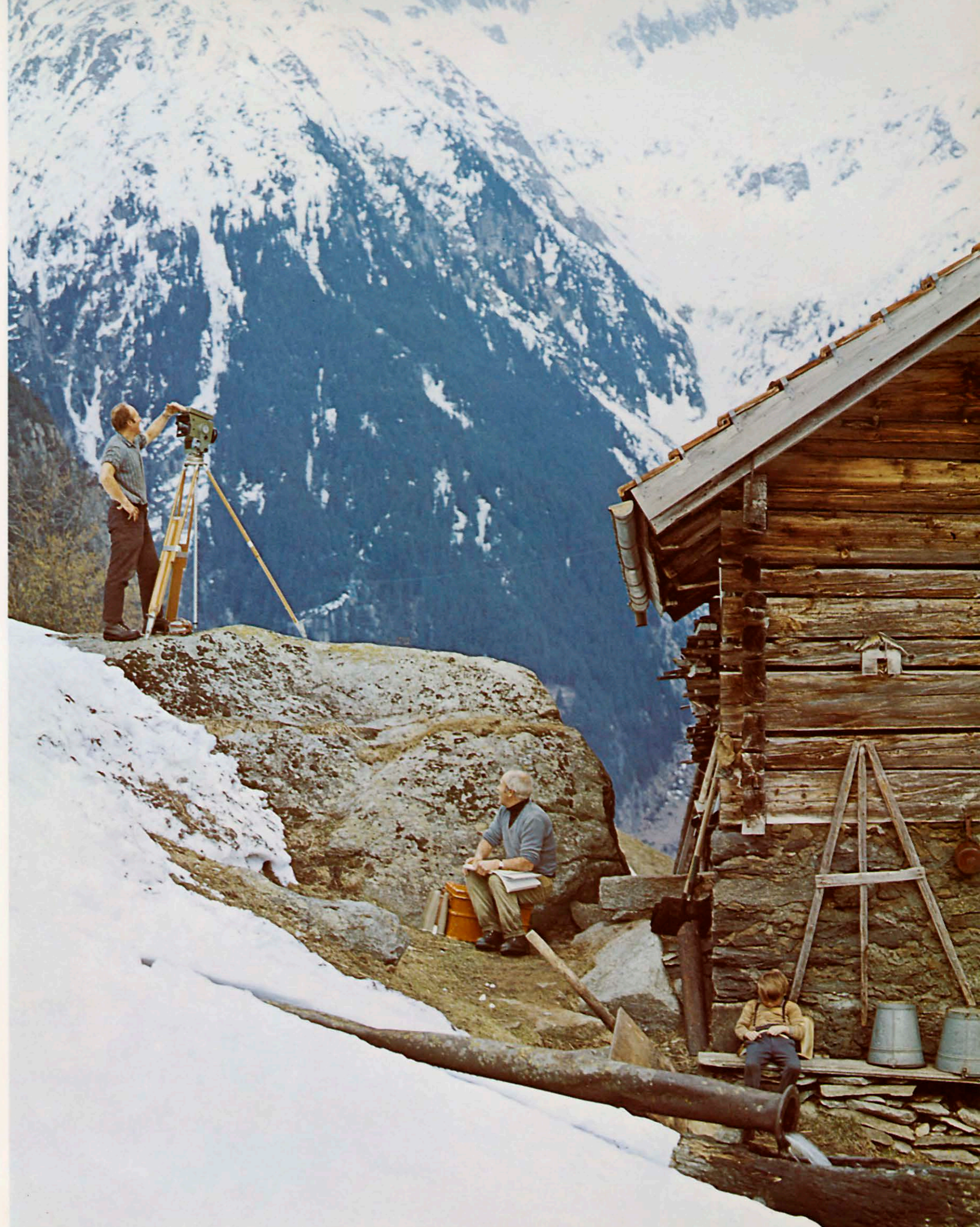
Verdichtung eines Festpunktnetzes bei Göschenen (Uri) mit dem elektrooptischen Distanzmessgerät Kern DM 2000
