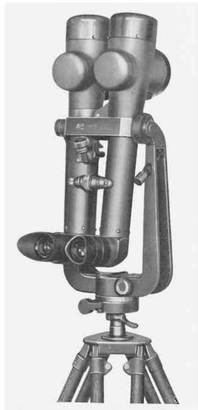
Scheerenfernrohr 12x72 mit Teilkreis und Geländewinkelmesser. Constr. Dr. H. Wild
