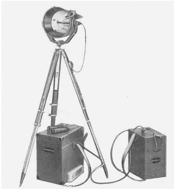
Signalgerät mit Spiegel von 280 mm Durchmesser für Distanzen bis 30 km am hellen Tage, Lampe 10 W Kompl. Ausrüstung mit Kurbeldynamo für 8 Volt
