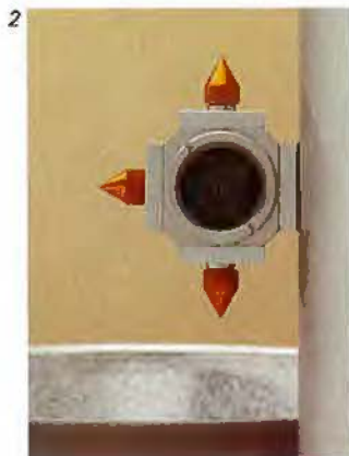
1 Strahlengang vom Distanz- messer (Kern DM 502/DM 503) durch das Umienkprisma auf den Kleinreflektor.
