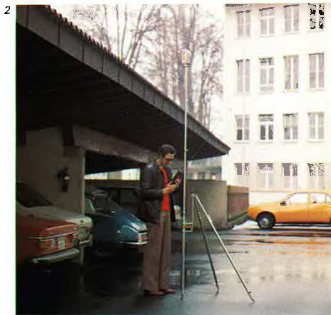
2 Reflektorstativ mit 1-m-Verlängerung zum direkten Überqueren von Hindernissen
